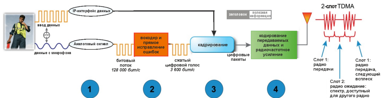
Рисунок. – Функциональная схема передачи цифровых пакетов
