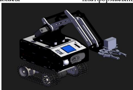
5-ші нұсқа. ШТЖКАҰЖА манипуляторлық агрегатының тұжырымдамасы
