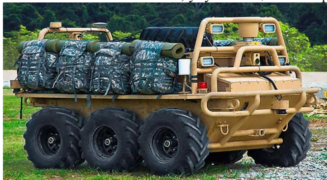
Рисунок 4. – Система поддержки миссии отделения (SMSS - на англ.)
