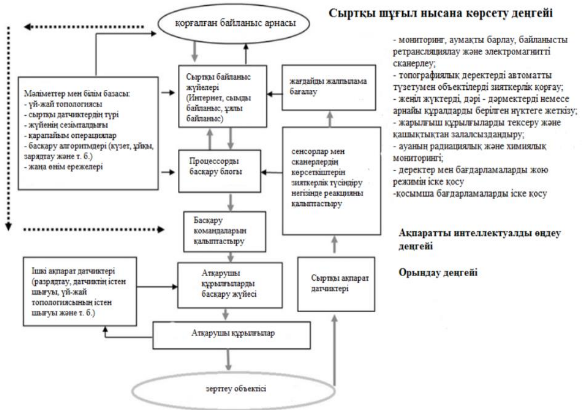
2-сурет. – Шынжыр табанды автономды ұшқышсыз жерүсті аппараттарының (ШТЖКАҰЖА) функционалды диаграммасы
